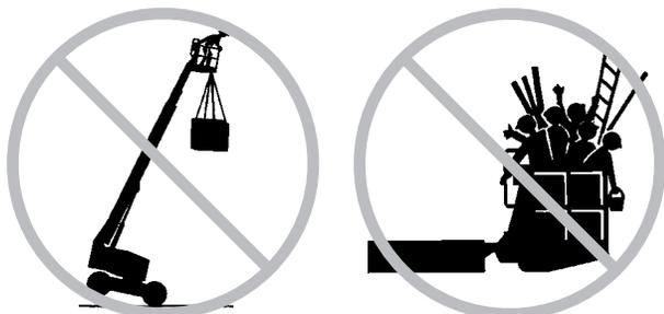
No coloque escaleras ni andamios en la plataforma ni los apoye en ninguna parte de la máquina.
