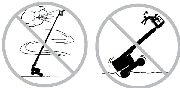
Cuando conduzca la máquina en posición replegada a través de terrenos irregulares, escombros, superficies inestables o deslizantes, o cerca de agujeros y pendientes, extreme las medidas de precaución y conduzca a velocidad reducida.
