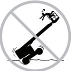
Cuando conduzca la máquina en posición replegada a través de terrenos irregulares, escombros, superficies inestables o deslizantes, o cerca de agujeros y pendientes, extreme las medidas de precaución y conduzca a velocidad reducida.
