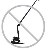
No confíe en la alarma de inclinación como indicador de nivelación. La alarma de inclinación sólo suena cuando la máquina se encuentra en una pendiente muy pronunciada.
