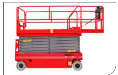
Mayor superficie de trabajo gracias a la plataforma extensible
