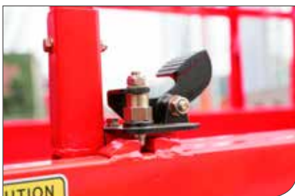
Bloqueo de la extensión de la plataforma mediante pedal
