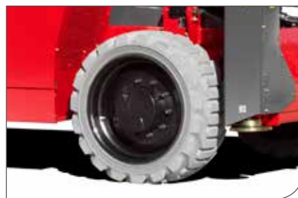
Amplios neumáticos todoterreno antihuella para mejorar la adherencia al suelo
