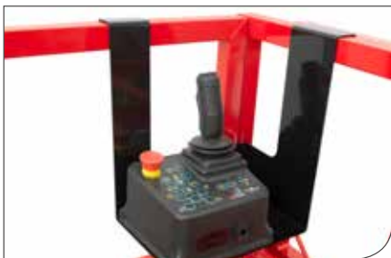
Joystick ergonómico y desmontable que puede retirarse tras finalizar el trabajo
