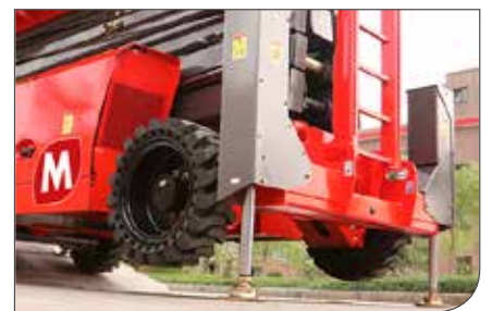
Estabilizadores hidráulicos con nivelación automática
