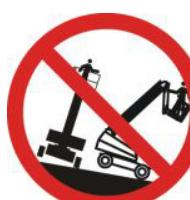
**NO** ascienda o descienda una pendiente de más del 45 % (tracción a las 4 ruedas). La conducción de la plataforma con el soporte de elevación en posición elevada debe ser efectuada únicamente sobre superficies firmes y niveladas.
