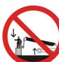
**NO** utilice el soporte de elevación para empujar o tirar de objetos, o para elevar el vehículo.
