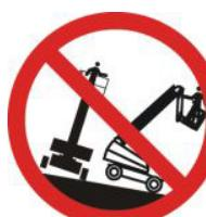
**NO** eleve o conduzca la plataforma elevada en una pendiente. La conducción con la plataforma elevada se debe efectuar únicamente sobre una superficie firme y nivelada.
