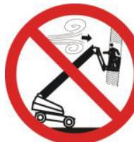
**NO** incremente la superficie lateral de la plataforma. El incremento de la superficie expuesta al viento disminuirá la estabilidad de la MEWP. Evite montar toldos sobre la plataforma.
