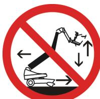
**NO** utilice la MEWP si no funciona correctamente o si alguna de sus piezas está dañada o desgastada.
