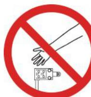
**NO** altere o inhabilite los interruptores limitadores u otros dispositivos de seguridad.
