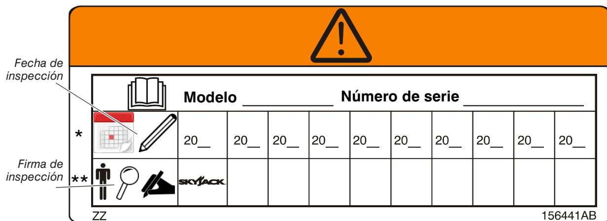
**Figura 33** Esta placa adhesiva está situada en la cubierta del compartimiento de control. Este rótulo debe completarse una vez que se haya realizado la inspección anual. No utilice la MEWP si no se ha registrado una inspección en los últimos 6 meses.
