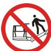
**NO** trepe por el brazo de la estructura del soporte de elevación. Está prohibido.
