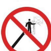
**EVITE** los peligros de aplastamiento. Cuando eleve o conduzca la plataforma aérea, tenga en cuenta los peligros de aplastamiento. Mantenga todas las partes del cuerpo dentro del perímetro de la MEWP.
