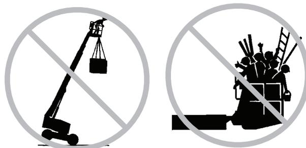
No coloque escaleras ni andamios en la plataforma ni los apoye en ninguna parte de la máquina.
