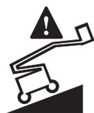
Si la luz está encendida, quiere decir que la máquina no está nivelada. Cuando esta luz esté encendida, sonará la alarma de inclinación. Sitúe la máquina en una superficie firme y nivelada.
